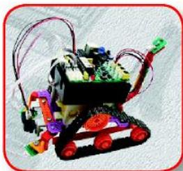
Nous arrivons au modèle ROBO-BOX qui se programme comme notre ROBOT FORMULA par logiciel et transfert du programme par port USB.
