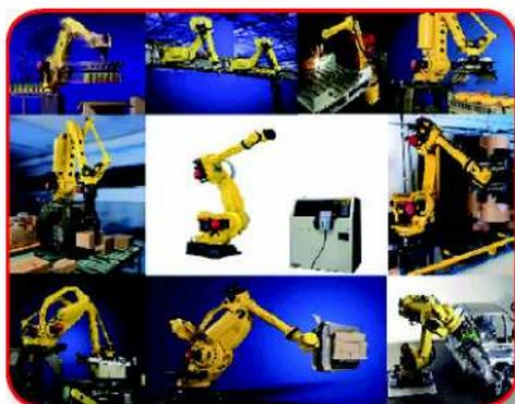
Un robot se compose d'une partie mécanique, le bras lui-même, d'une armoire de commande composée d'une unité centrale qui pilote les **électroniques de commande d'un ou plusieurs axes qui en assure** l'asservissement, de variateurs de vitesse et d'un langage de programmation spécialisé qui permet de commander le robot.
